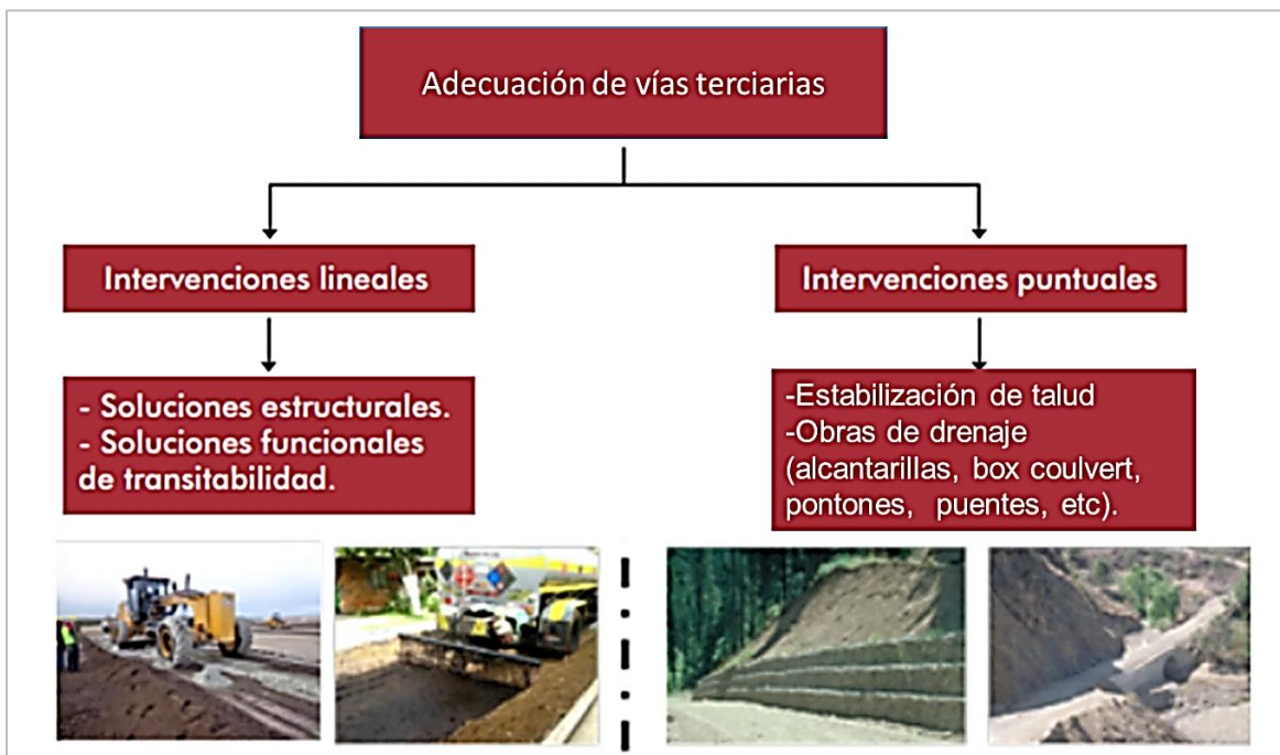
Figura 2-21 Esquema general de adecuación de vías
