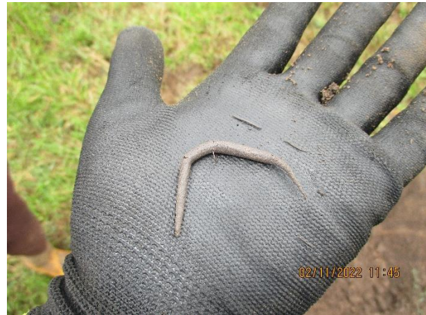
Fotografía 3.2.1-22 Prueba índice de plasticidad en suelo transportado lacustre en la vereda Unión de San Juan, Puerto López
