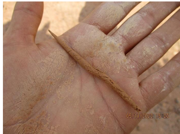
Fotografía 3.2.1-14 Prueba índice de plasticidad para el suelo residual arcilloso de la Formación Guayabo Miembro Superior en la vereda Yurimena, Puerto López
