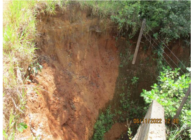
Fotografía 3.2.2-9 Deslizamiento traslacional en la Formación Guayabo Miembro Superior – intervalo arenoso, vereda Yurimena, Puerto López
