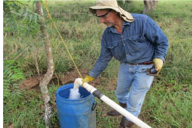
Fotografía 3.2.7-14 Aforo de caudal de bombeo PB-02 (Pozo CPO5-005-P-El Boral), vereda San Isidro, municipio de Cabuyaro
