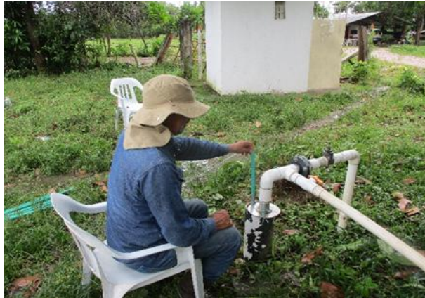
Fotografía 3.2.7-23 Medición de niveles dinámicos PB-07 (Pozo P-245 San Paulo), vereda San Pablo municipio de Puerto López
