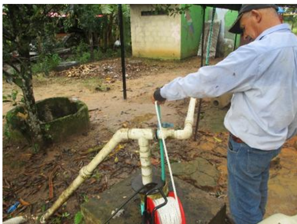
Fotografía 3.2.7-17 Medición de niveles dinámicos PB-04 (Pozo P-232 – A. Rionegro), vereda San Luis de Río Negro, municipio de Puerto López
