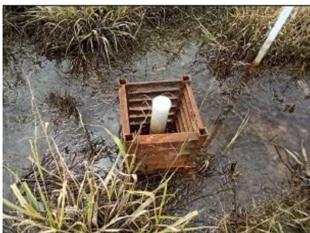
Fotografía 3.2.7-7 Piezómetro Pz No. 1_Indico, vereda San Isidro, Municipio de Cabuyaro
