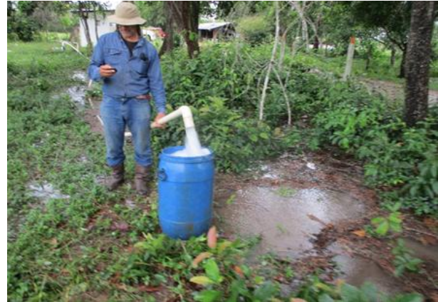
Fotografía 3.2.7-24 Aforo de caudal de bombeo PB-07 (Pozo P-245 San Paulo), vereda San Pablo municipio de Puerto López
