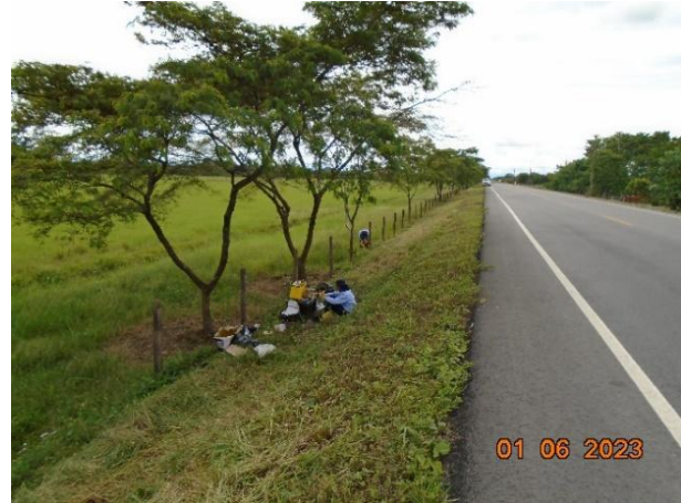
Fotografía 3.2.7-10 Ejecución de SEV-9
