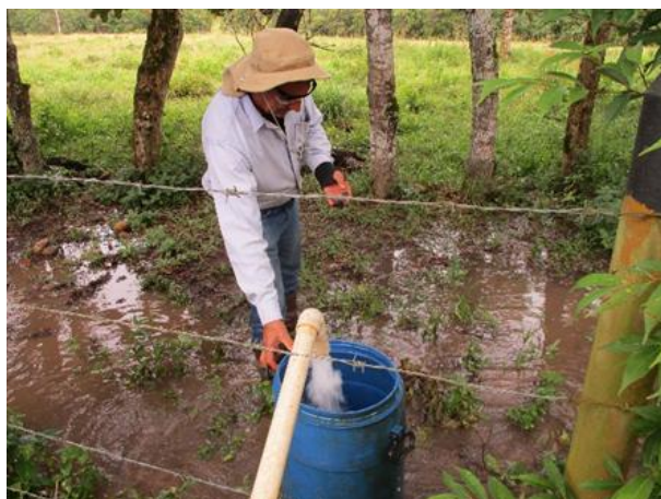
Fotografía 3.2.7-18 Aforo de caudal de bombeo PB-04 (Pozo P-232 – A. Rionegro), vereda San Luis de Río Negro, municipio de Puerto López
