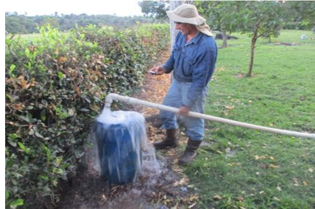
Fotografía 3.2.7-16 Aforo de caudal de bombeo PB-03 (Pozo P-257-La Esmeralda), vereda Alto Menegua, municipio de Puerto López
