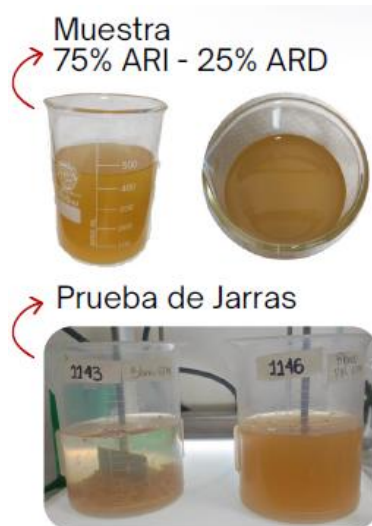
Figura 4.3-17 Muestra implementada y prueba de jarras a realizar a las ARD y ARnD para las actividades desarrolladas en el Bloque CPO-5
