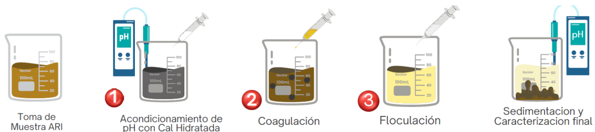
Figura 4.3-18 Tratamiento en 3 etapas a realizar a las ARD y ARnD para las actividades desarrolladas en el Bloque CPO-5
