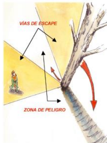
Figura 4.5-5 Identificación de vía de escape y zona de riesgo
