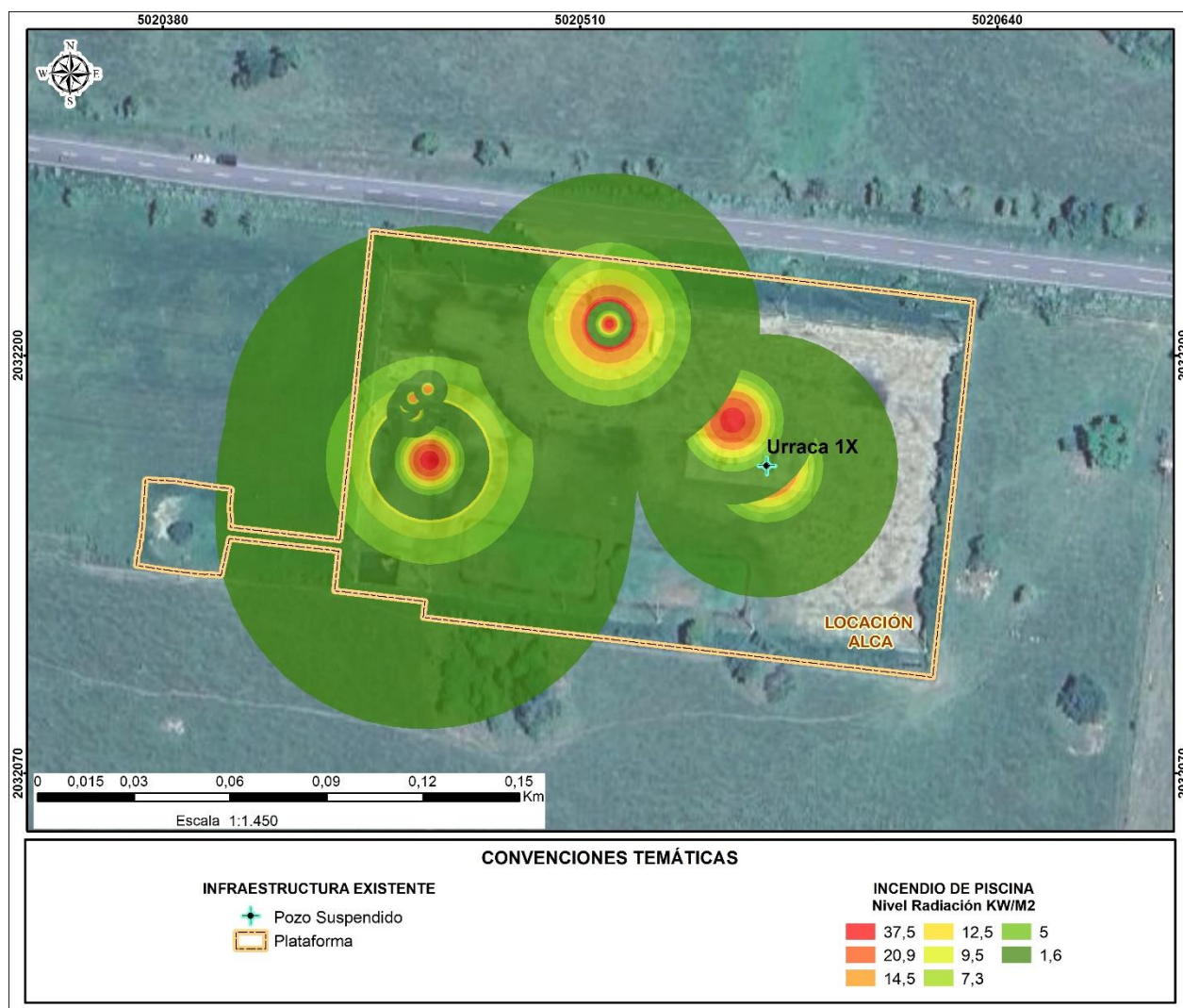
Figura 9-55 Corredores de afectación directa por incendio de piscina locación Alca
