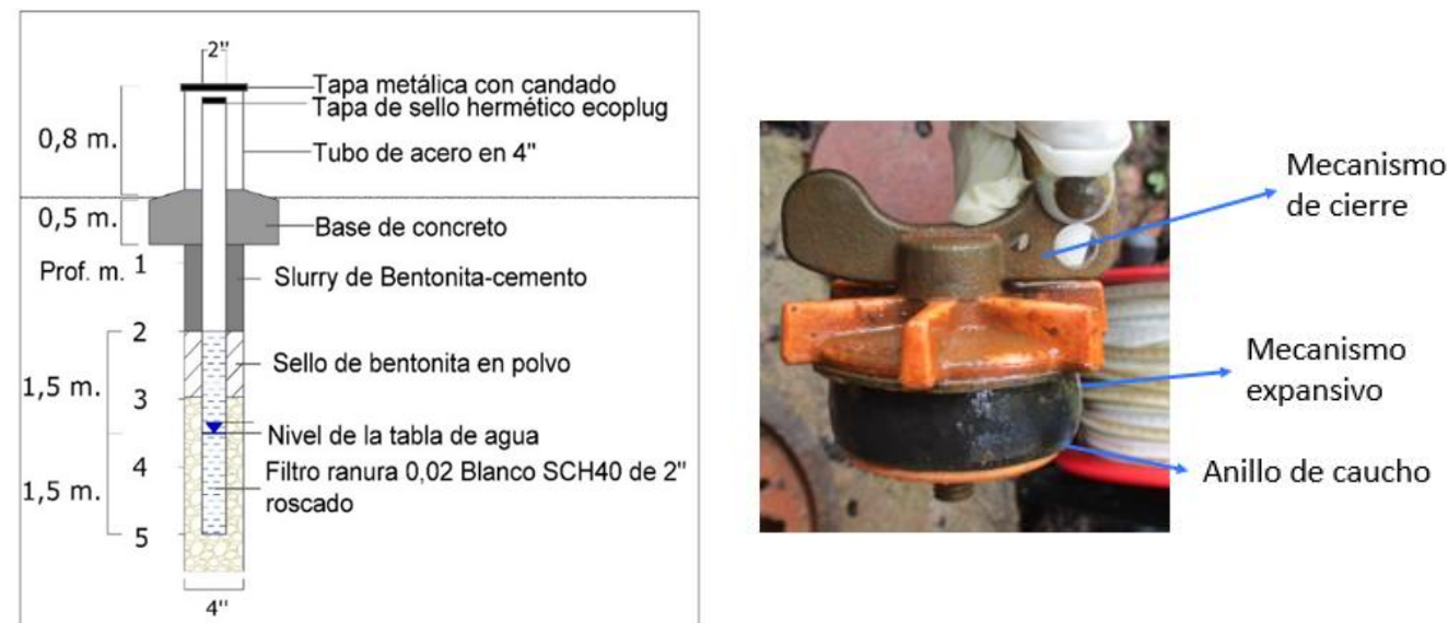
Figura 1. Diseño esquemático tipo para la construcción de un pozo de monitoreo y diseño tapón EcoPlug
