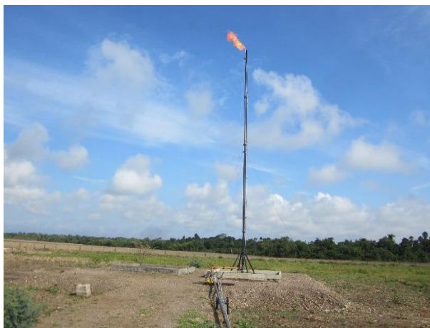
Fotografía 2-9 Incineración temporal de gas - TEA
